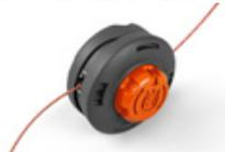
La testina filo R25 con sostituzione rapida ottimizza e semplifica il processo di ricarica del filo. Consente la ricarica rapida del filo senza smontare la testina. Quando è troppo corto, batti la testina a terra per far uscire il nuovo filo. Facile e affidabile!
