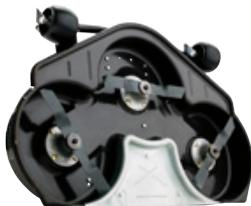
I nostri gruppi di taglio Combi offrono due sistemi di taglio differenti: BioClip® e scarico posteriore.
